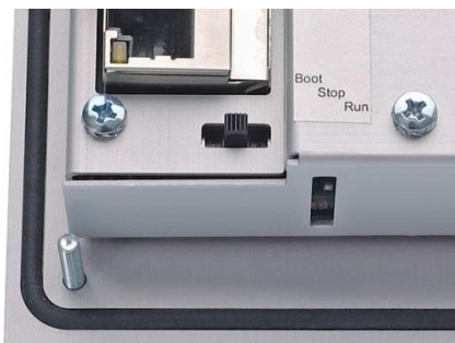
Abb. 5-1: Betriebsartenschalter auf der Rückseite einer PLM 707
