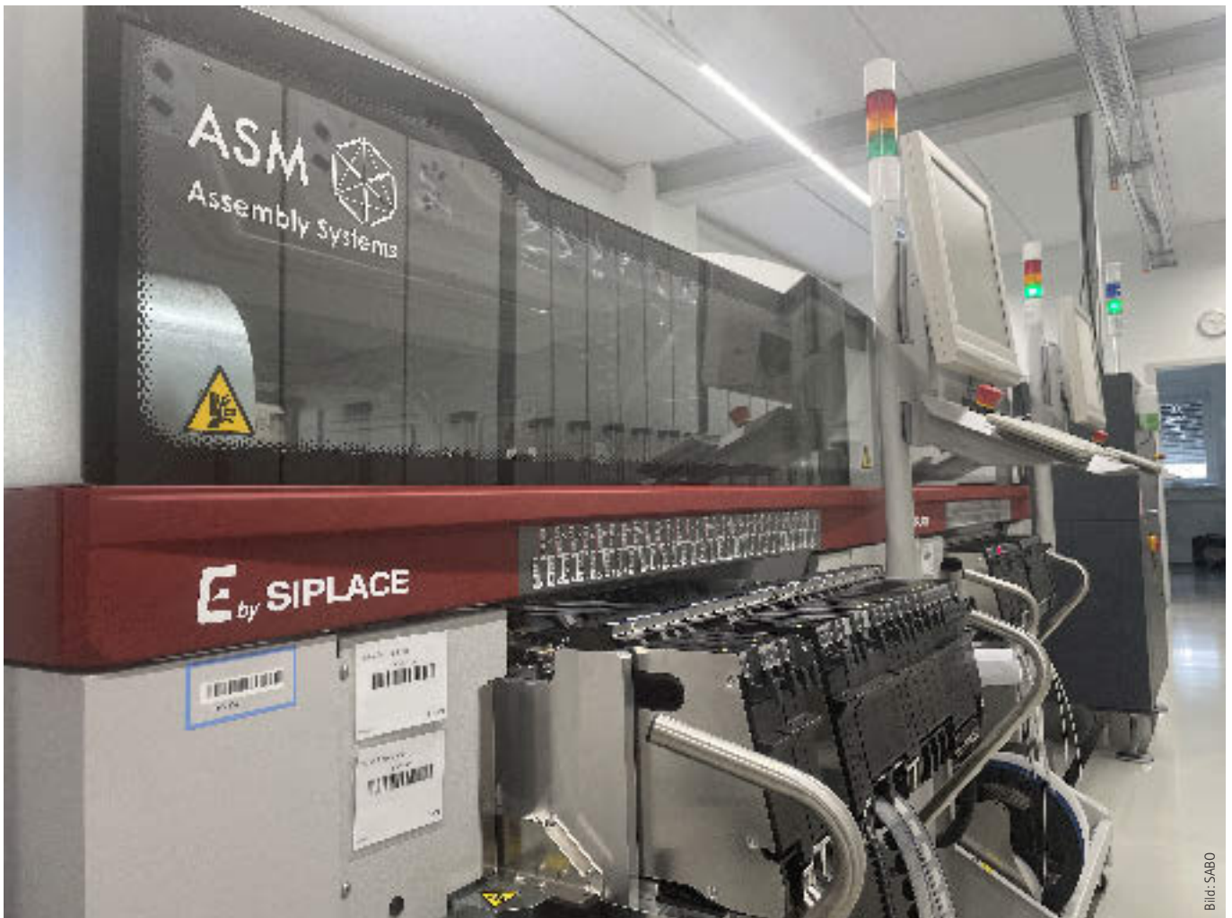
Die neue E by Siplace Linie bietet SABO erheblichen Mehrwert: Sie ist präziser und flexibler als die alte Lösung und ermöglicht die Automatisierung der OSC-Bestückung – Mitarbeiter sind so frei für andere Aufgaben
